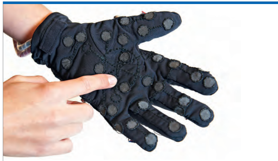
Grâce au «Lorm Glove» une communication à distance entre sourds-aveugles est possible.
